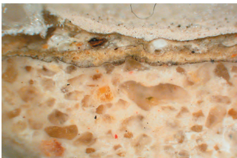
Typická skladebnost na vzorku 6: štuk s vrstvičkou nečistot, tenké okrové a šedé nátěry, silný novodobý světlý nátěr - (celá laboratorní zpráva v příloze)
